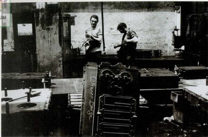
Au premier plan, entre deux machines à mouler, des plaques modèle pour dessus de cuisinière Franco-Belge. Coste-Caumartin travaille alors de plus en plus en sous-traitance pour d'autres grandes marques. Photographie tirée de l'ouvrage "Un Chant rauque" – Catherine Gardone – GRANIT C.A.C.de Belfort – 1987.
