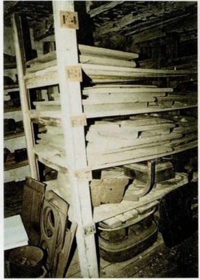
Magasins à modèles Varigney – les différents modèles sont rangés au magasin avec la planche à mouler correspondante
