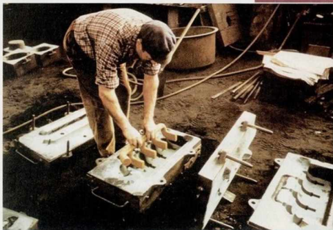
Hubert Carteret procède au remoulage d'un collecteur d'échappement de moteur CERES, c'est-à-dire à la mise en place du noyau (partie creuse de la pièce). Derrière lui, au fond, des moules de marmites préparés à la main.
