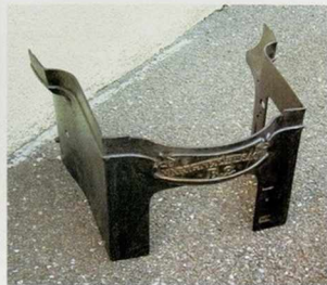
Modèle en fonte de façade de fourneau B2, Variigny. Correspond à la moitié de la cuve.
