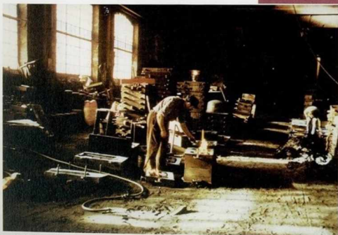
Séchage d'un moule à l'alcool
