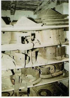
Magasins à modèles Varigney – les différents modèles sont rangés au magasin avec la planche à mouler correspondante
