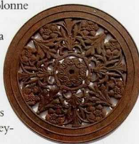
Matrice en alliage à base d'étain d'un couvercle très ouvragé de fourneau de Vy-le-Ferroux Seconde étape : modèle en fonte coulé à partir de la matrice. Il servira au moulage.
