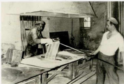
La préparation des pièces... Les pièces sont émaillées sur une table en fonte qui sert aussi à les redresser. A. Varinich et A. Jeanmougin à l'émaillerie du Magny-Vernois : la pièce chauffée à 800 ° est saupoudrée d'une couche d'émail blanc, retourne au four pour vitrification puis reçoit un émail de couleur et repasse au four une dernière fois.
